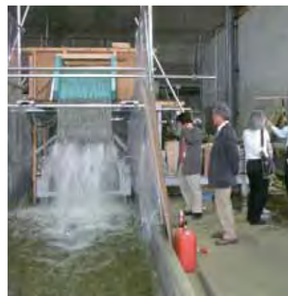
試作水車の室内性能試験
