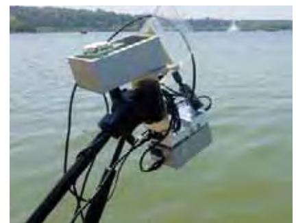
開発したマルチパラメータ環境計測装置の測定試験の様子（場所：水戸市・千波湖）
