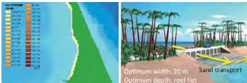
図-5:コースウェイ開削による砂堆積量の数値シミュレーション結果
