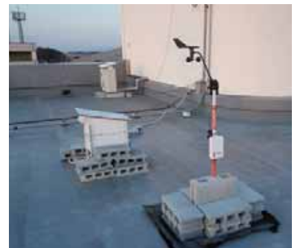
CO 2 濃度計測のために手作りで作り上げた電子百葉箱と風
