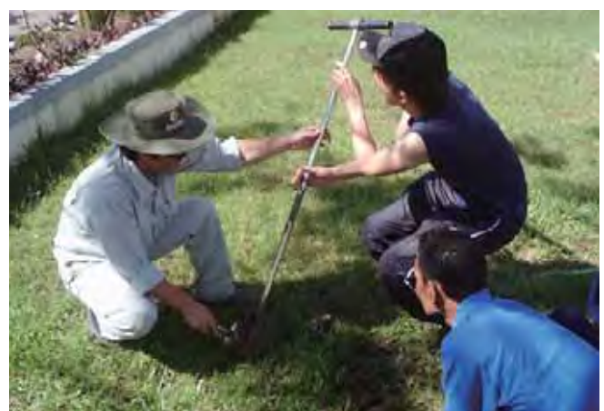
観測井戸掘削の様子
