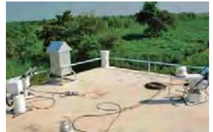
大気汚染常時監視局において、オゾン・窒素酸化物・PM2.5(粒径2.5 \mu m以下の微小エアロゾル)・黒色炭素エアロゾルの測定装置
