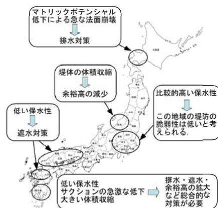
図 1.2-(3) 河川堤防堤体材料の降雨に対する脆弱性評価と対策マップ
