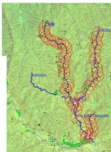
図 3.1-(5) 小流域のマイクロ水力開発可能地点の抽出例
