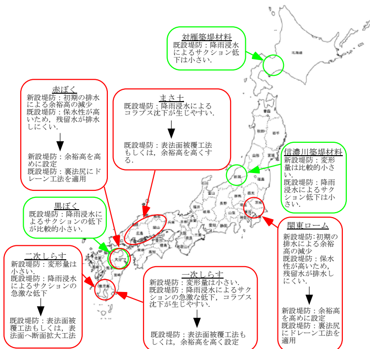
図 1.2-(1) 繰り返し一次元保水性実験および不飽和三軸圧縮試験の結果に基づく、降雨浸透が繰り返し頻発することによる河川堤防や高水敷・河岸の脆弱性評価と適応策マップ
