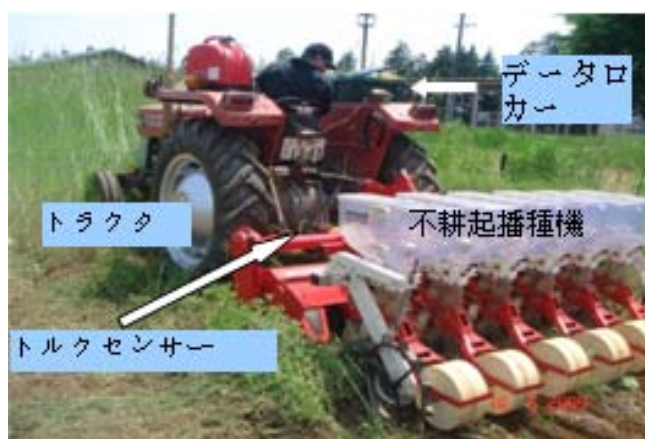
図 2.4-(4) カバークロップ利用条件下での汎用型不耕起播種機の作業動力の測定。
