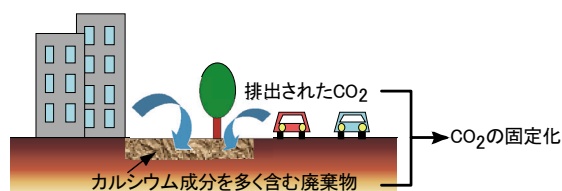
図 1.2-(4) 廃棄物による CO 2 固定化の概念図
