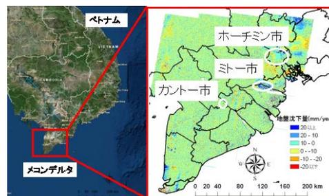
図 1.3-(1) 川瀬らが特定したメコンデルタの地盤沈下地域<sup>1)</sup>
