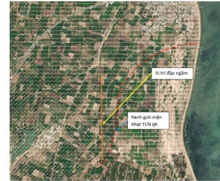
Hình 4.49: Vị trí đập ngầm được lựa chọn Vector màu trắng chỉ hướng dòng chảy NĐĐ
